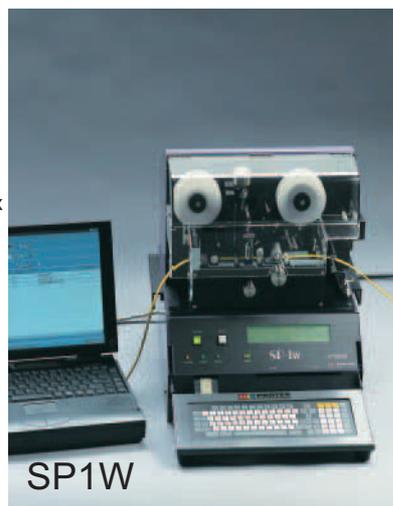
SP1W - машина для производства маркировочных рукавов по собственным нуждам. На профиль наносятся обозначения и режется на отрезки нужной длины. Машина управляется встроенной клавиатурой. Ввод информации и управление может производиться также с компьютера через порт RS232 программой PARTEX WINSIGN PRO.
