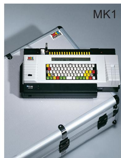
Минипринтер MK1 предназначен для нанесения обозначений на маркировку. Печать может производиться с компьютера через порт RS232, под управлением программы WINSIGN PRO. Также на MK1 можно печатать без компьютера, вводя обозначения с клавиатуры. Печать струйная с гравировкой.
